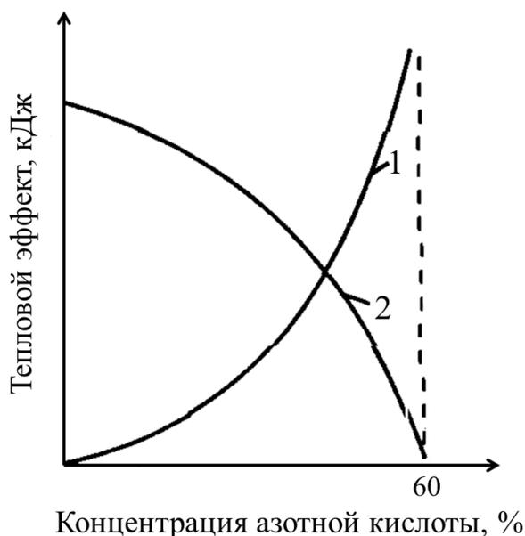
Рис. 4.1 Зависимость теплового эффекта от концентрации азотной кислоты: 1 – тепловой эффект нейтрализации с учетом тепла разбавления кислоты; 2 – тепло растворения нитрата аммония
