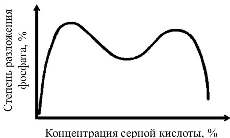
Рис. 3.3 Зависимость степени разложения фосфата от концентрации серной кислоты
