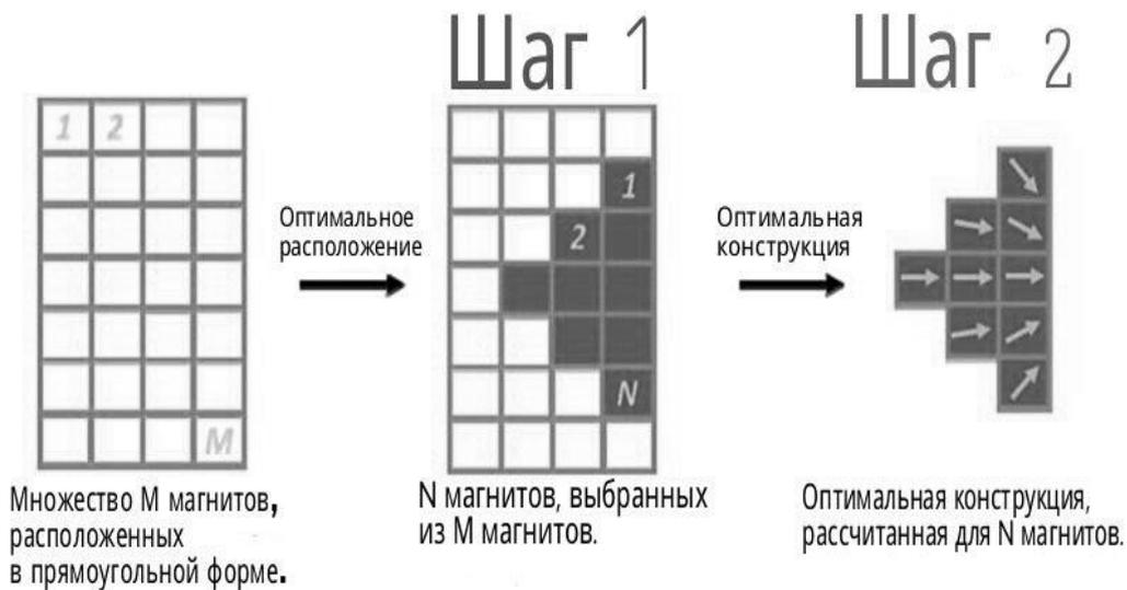
Рис. 2. Оптимизация конструкции наборных магнитных систем
