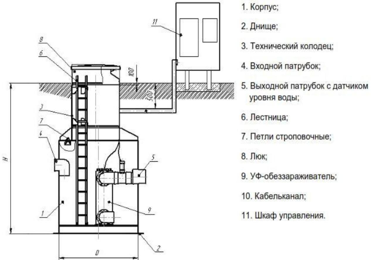
*Установка ультрафиолетового обеззараживания воды*
