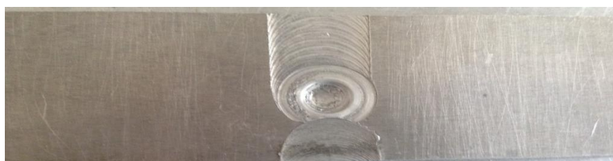
Рис. 3а. Фотография пластины №3 с нанесенными дефектами
