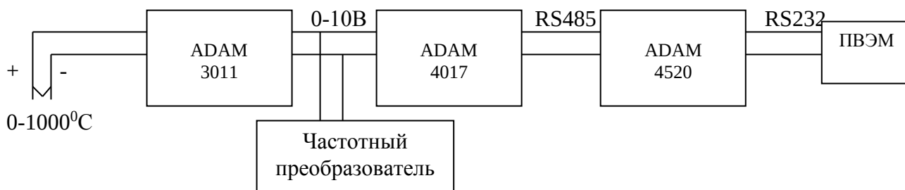
Рис. 1. Существующая схема управления температурой расплава в плавильнике
