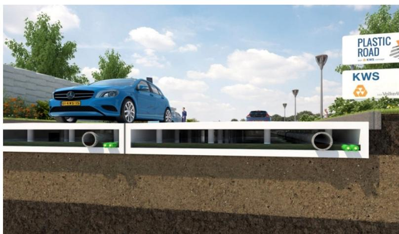
Рис. 1. Схема устройства «пластиковой» дороги [3]
