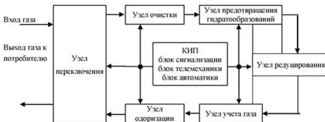
*Рис. 1. Основные стадии газораспределительной станции*
