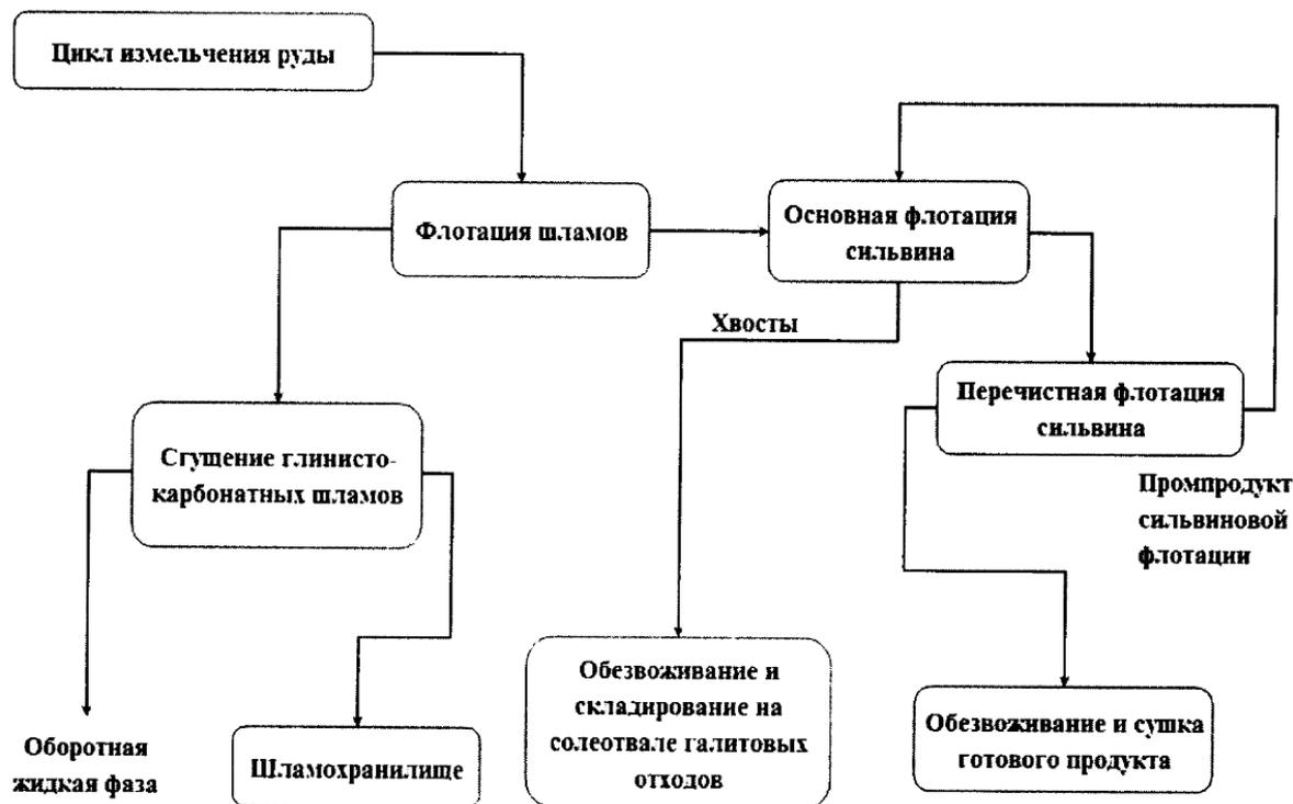
**Флотационная переработка калийной руды с возвратом промпродукта перечистой сильвиновой флотации в питание основной флотации сильвина**
