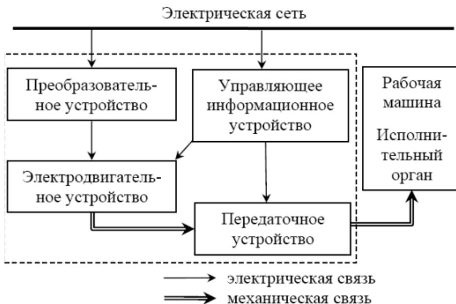
Рис. 1. Структурная схема автоматизированного электропривода
