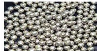
Карбонильная никелевая дробь – диаметр 8-20 мм
